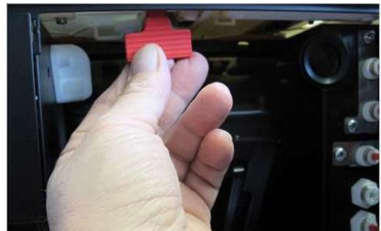
5. Verriegelungsschieber bis zum Anschlag hinein-schieben.
