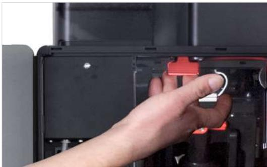
1. Verriegelungsschieber bis zum Anschlag nach vorn ziehen.
