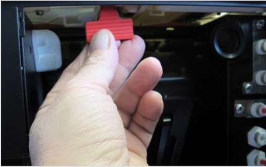
7. Verriegelungsschieber bis zum Anschlag hinein-schieben.
