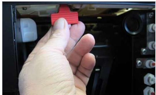
5. Verriegelungsschieber bis zum Anschlag hineinschieben.
