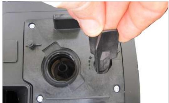
3. Mahlgrad bei Bedarf mit dem Mahlwerk-Einstellschlüssel einstellen.
