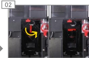
02 Brühmodulverriegelung im Gegenuhrzeigersinn lösen.
