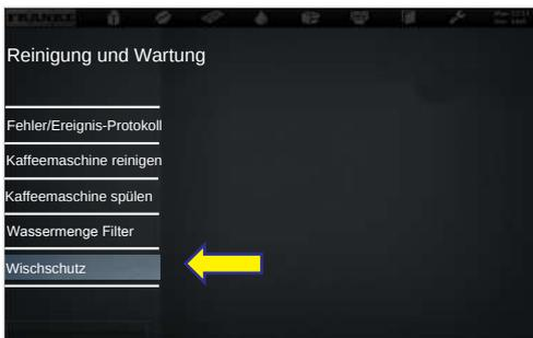
⇒ Die Bedienoberfläche ist für 20 Sekunden gesperrt.
