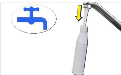
6. Neue Filterpatrone in Filterhalter einsetzen und im Uhrzeigersinn festdrehen.
