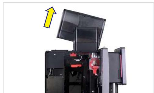
3. Bohnenbehälter leeren, reinigen und trocknen.
