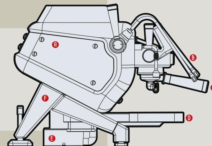
**E** Die Zulauf- und Ablaufrohre und die Versorgungsanschlüsse befinden sich in einer Ausbuchtung, die dem sichtbaren Teil unterhalb der Maschine Eleganz und Ordnung verleiht. Dadurch führen alle Kabel und Rohre direkt in die Tresenöffnung und das Problem der sichtbaren Kabel erhöhter Kaffeemaschinen wird vermieden. Rohre und Kabel sind durch eine Umflechtung aus Edelstahl geschützt.
